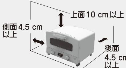
※木製の壁、家具などの周囲の可燃物から左図の距離を離して使う。
