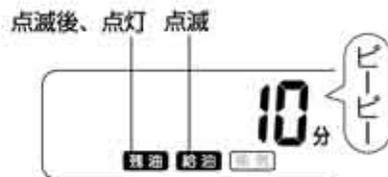
**3**  に変わってから油切れ消火までは  の表示を続けます。その後ブザーが5秒間鳴り、**給油** 表示が点滅し、油切れ消火が近いことをお知らせします。ブザーが5秒間鳴っている間は **残油** 表示は点滅します。それ以外は点灯します。
