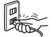
コードを引っ張ると、コードが破損し、感電・ショート・火災の原因になります。
