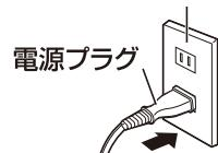
※電源プラグをコンセントにさし込む時は、必ず「切換スイッチつまみ」が「切」の位置になっていることを確認してください。
