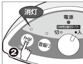
※チャイルドロックランプが点灯したままで、次のような 場合は、一度チャイルドロックを解除してから、電源スイッチつまみを「切」にし、再度「入」にしてください。
