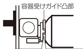
マグネットと容器（ボンベ）の間に隙間がないように取り付けてください
