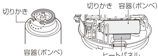
⑤容器(ボンベ)の切りかきを容器受けガイドの凸部に合わせ、容器(ボンベ)を前側に押しながら容器セットレバーを「着」の位置まで押し下げて、容器(ボンベ)を固定する。
