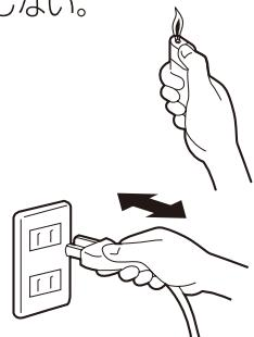
電気器具（換気扇その他）のスイッチの「入・切」をしない
