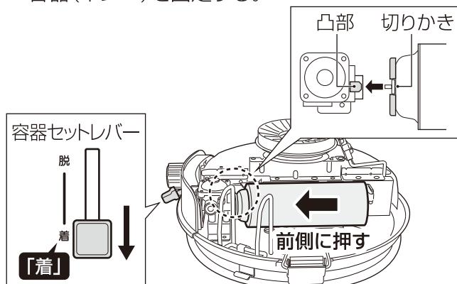
⑥本体上部の取り外しと反対の手順で取り付け、本体フック(左右2カ所)を確実にロックする。
