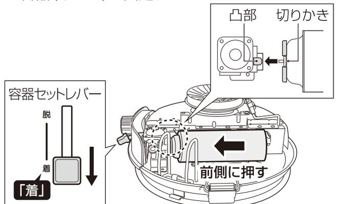
⑥本体上部の取り外しと反対の手順で取り付け、本体フック（左右2カ所）を確実にロックする。
