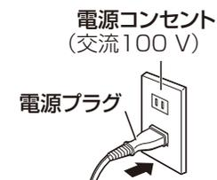
※電源プラグをコンセントにさし込む時は、必ず「切換スイッチつまみ」が「切」の位置になっていることを確認してください。
