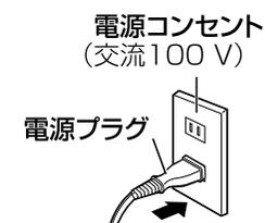
※電源プラグをコンセントにさし込む時は、必ず「切換スイッチつまみ」が「切」の位置になっていることを確認してください。
