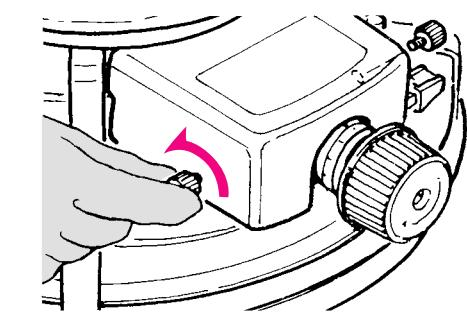
⑤対震自動消火装置の振子を指で押して消火装置を作動させてください。
