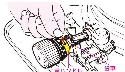
④黄ハンドルを押さえ、クラッチハンドルを手前に引き、そのまま右方向に1目盛り回し次の数字にします。数字が上がったら手をゆるめ、クラッチハンドルを黄ハンドルにはめてください。
