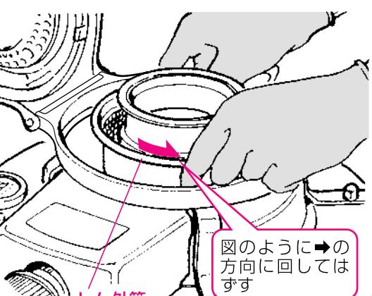
図のように→の方向に回してはずす
