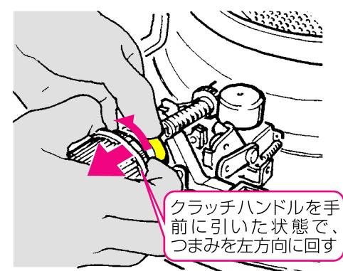
⑫クラッチハンドルを手前に引いた状態で、黄ハンドルを→印の方向に回して、ハンドルの赤い線をクラッチハンドルの「3」に合わせてください。
