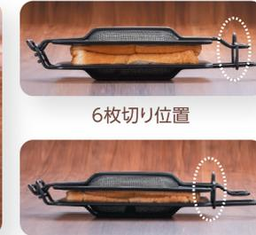
上プレートは厚さ調節をしてセットする。カチッと音が鳴るまでスライドフックを押し込みホットサンドメーカーをロックする。(スライドフックは手前側が6枚切り位置、奥側が8~10枚切り位置)
