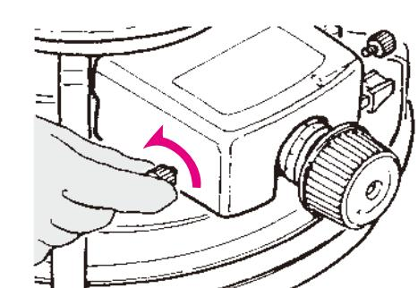
⑤対震自動消火装置の振子を指で押して消火装置を作動させてください。
