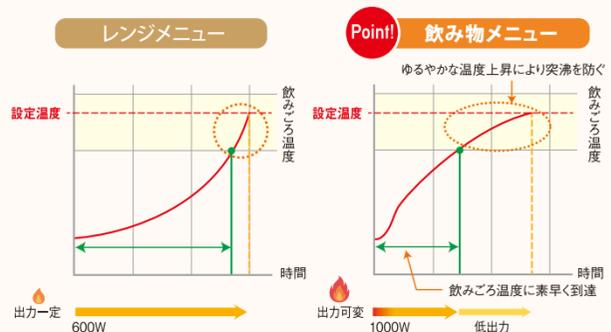
赤外線センサーが飲み物の温度を瞬時に検知。仕上がりは40℃~70℃まで5℃単位でお好みの温度設定ができ、あたため中の温度も確認できるので安心です。突沸しやすい飲み物も、出力を自動で調節して素早く飲みごろ温度にあたためます。
